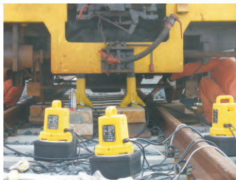
RC-25吨 复轨实例应用 RC-25 ton rail way application
